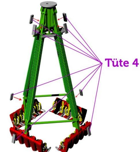
Alle Bauteile mit einem Tropfen Kleber fixieren /
